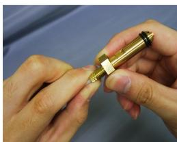
4-ガンシャフトにねじ込み、レンチを使ってしっかりと締付けます。
