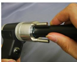
5-加圧ゲージを使いガンシャフトからボルト溶接面が加圧ゲージ上面と水平になるようにガンリングを回して調整します。最後にロックリングを締め付けロックし完了です。
