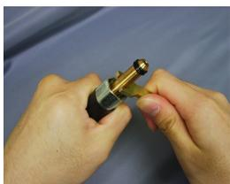
3-使用するスタッドボルトをチャックに差し込み、ストッパーでボルトの出シロを約2mmにします。そして、ストッパーに付いているリングで動かないようロックします。
