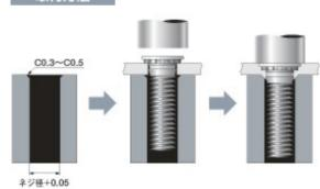
各サイズ別穴径で金属板に穴をあけ、 ヘッドが板と平らになるようプレスし ます。アンビルは板厚により次の2種 類を選択して下さい。
